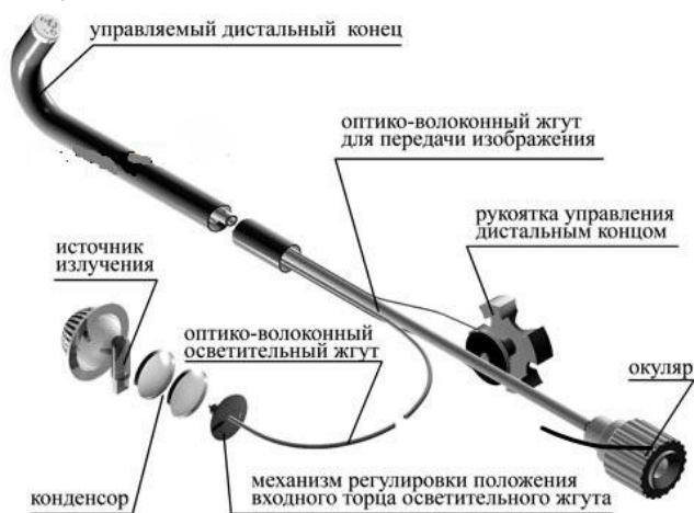
Рис.6. Устройство медицинского эндоскопа
